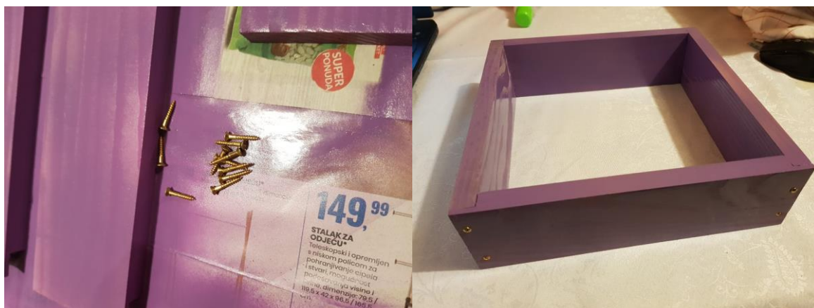
Slika 21: Spajanje letvica vijcima
