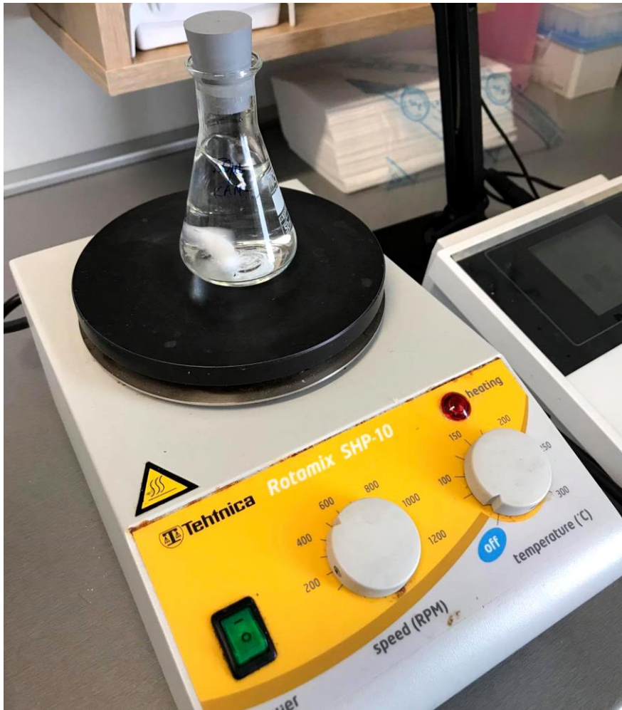
Slika 3. Miješanje otopine na magnetskoj miješalici „Tehnica - Rotamix SHP - 10" (Foto: M. Lerga, 2020.)
