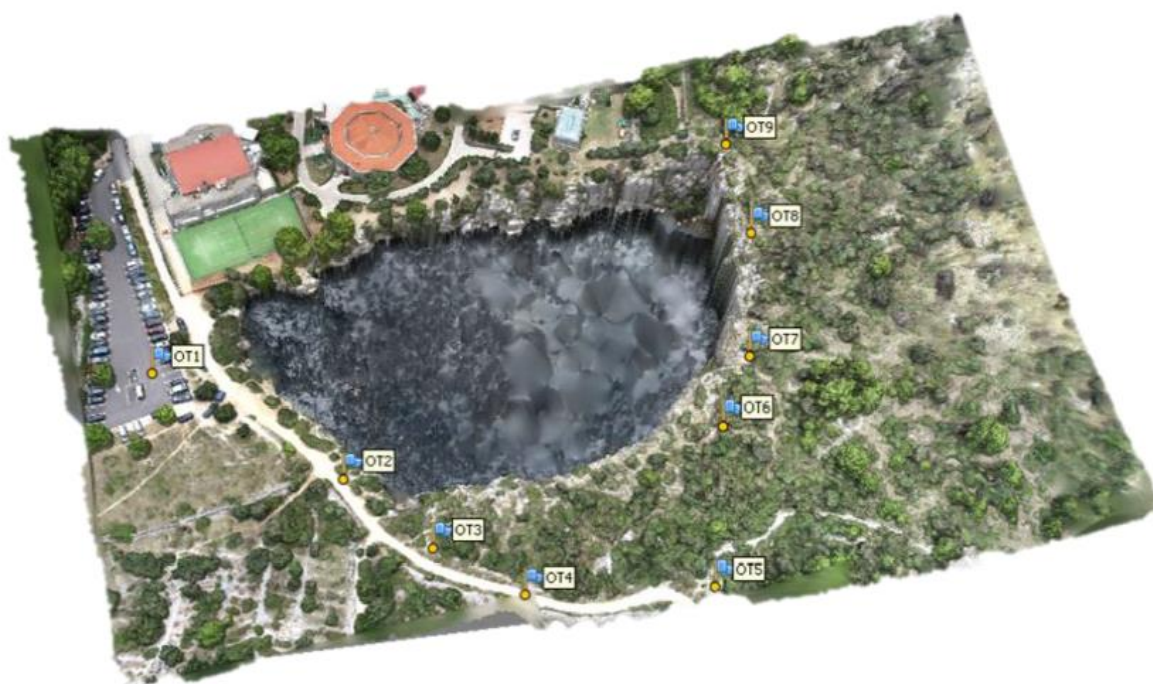
Slika 14. Označene orijentacijske i kontrolne točke na gustom oblaku točaka
