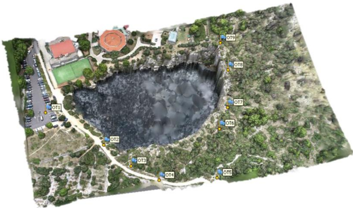
Slika 14. Označene orijentacijske i kontrolne točke na gustom oblaku točaka
