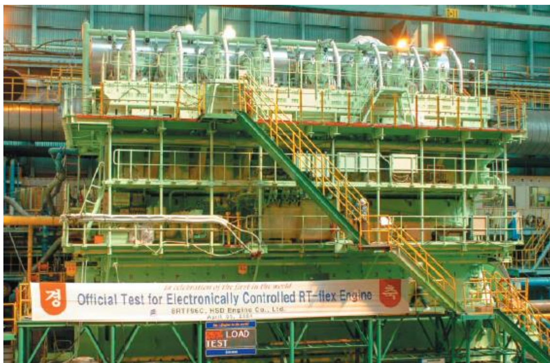
Slika 9. Prvi Sulzer RT-flex96C motor[17]
