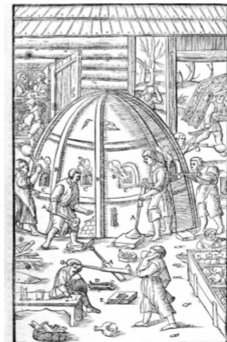
Sl. 5-G. Agricola, De re metallica , 1556; drvorez s prikazom staklarske peći na tri razine i detaljima (Davison, S., 2006, 148.)
