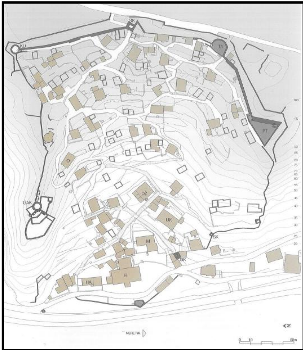
Slika 14: Tlocrt Počitelja: DK – donja kapija, GK – gornja kapija, GAK – Gavrankapetanova kula, KU – kulina, TA – tabija, PT – Pašina tabija, SK – sahat kula, DŽ – džamija, M-medresa, HA – hamam, O – oružarnica (prema: V. Sanković – Simčić, 2012, 165).
