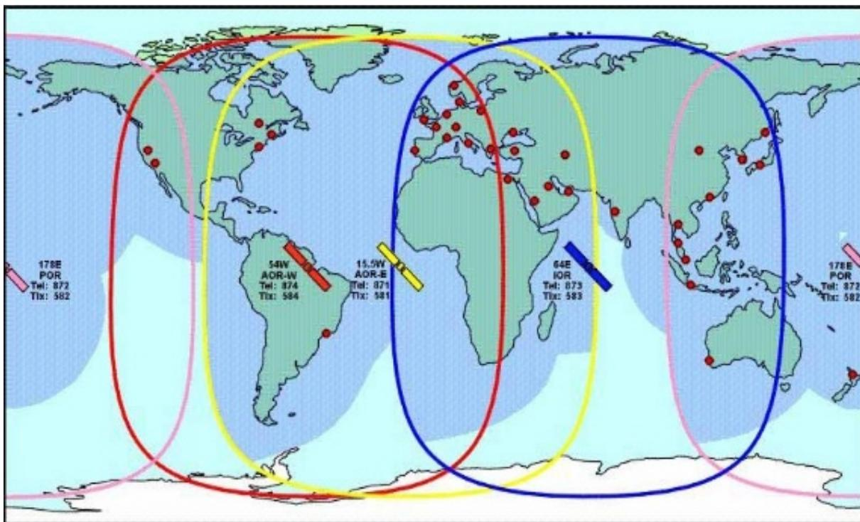
**Slika 3.** Raspored satelita Inmarsat sustava te pokrivenost zemlje
