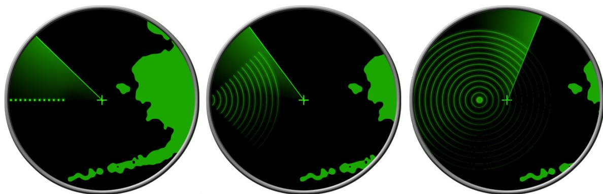
**Slika 4.** Prikaz signala SART uređaja na brodskom radarskom zaslonu
