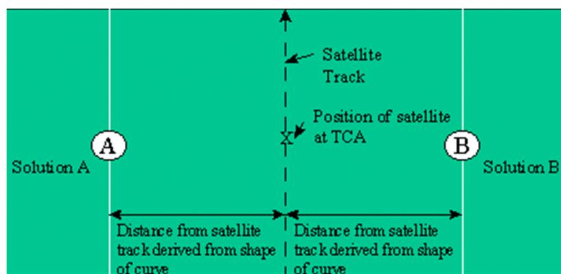
Slika 8. Prikaz određivanja mogućih lokacija EPIRB uređaja
