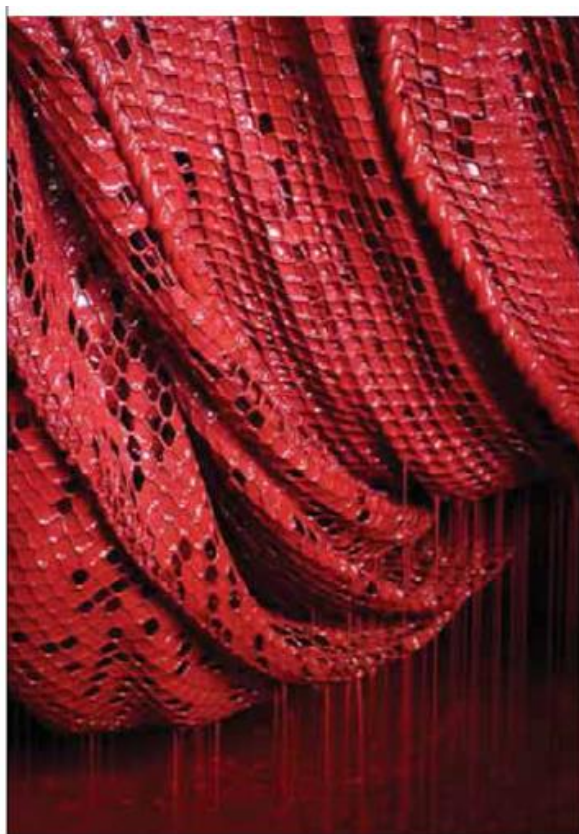
Slika 35. Nanošenje protuobraštajne boje na mrežni teg (Izvor: FAO, 2015)
