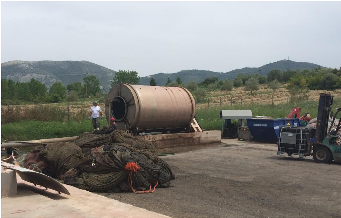
Slika 30. Uređaj za strojno pranje mreža na kopnu (Izvor: osobni foto materijal)
