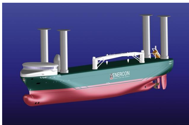
Slika 46. Flettner rotor on E Ship1
