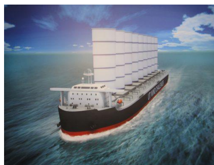
Slika 45. Teretni brod opremljen čvrstim jedrima, (IWSA)
