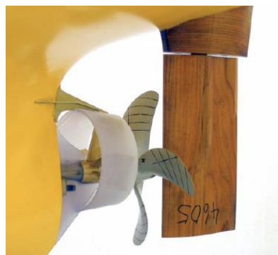
Slika 41. ModelBMS Mewis Duct®- ABS
