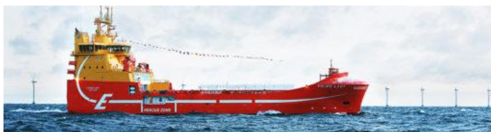
Slika 42. Viking Lady OSV LNG-hibridni pogon, DNV GL
