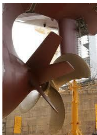
Slika 39. DSME pred kovitlajući stator
