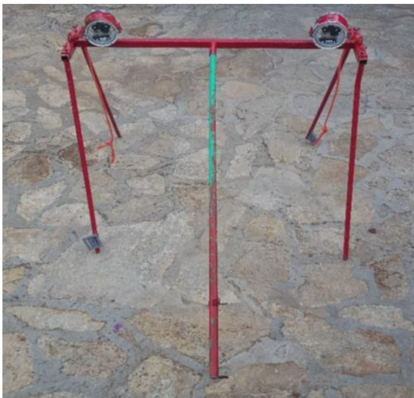
Slika 6: Stereo Bruv sustav korišten u istraživanju (Župan, 2021.)
