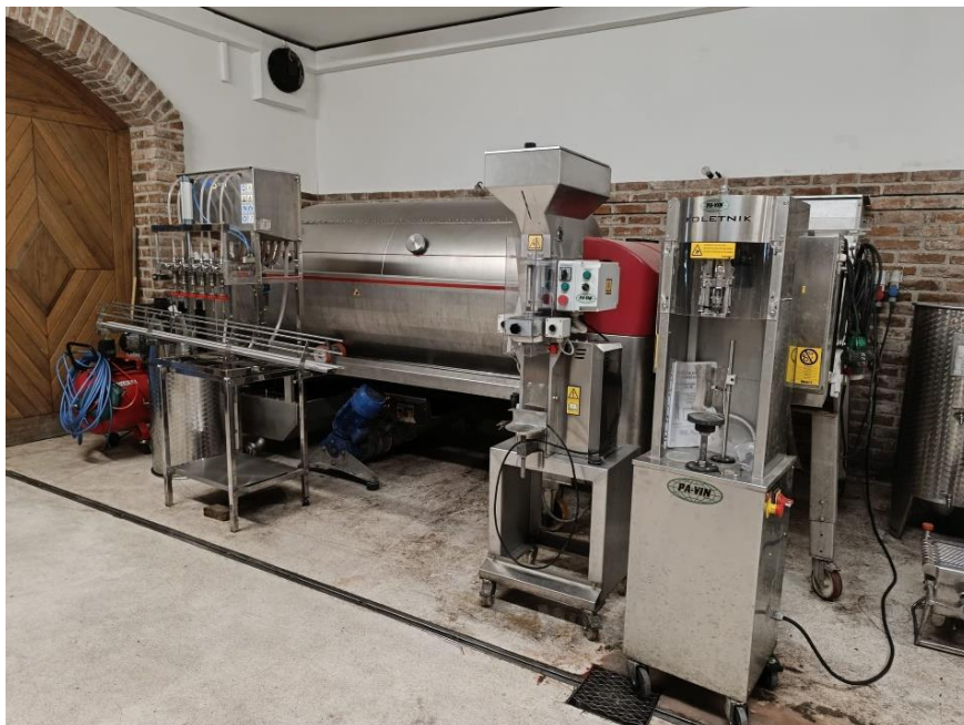
Prilog 6. Fotografija prikazuje pneumatsku prešu i strojnu opremu za preradu grožđa. Helena Severinac. Vinarija Šimanović, 2024.
