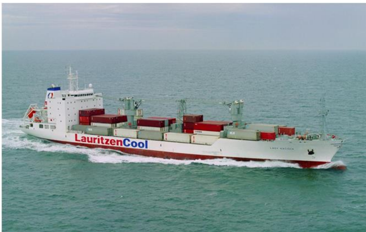
Slika 11. Uobičajeni brod hladnjača "Lady Račišće", izgrađen 2000. godine, ukupne zapremnine hladnjače od 17.000 m 3 i 260 TEU[11]
