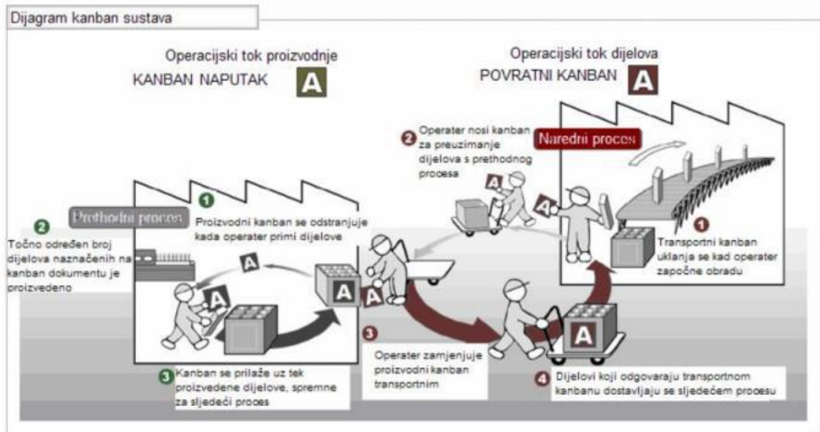
Slika 5. Prikaz kanban sustava
