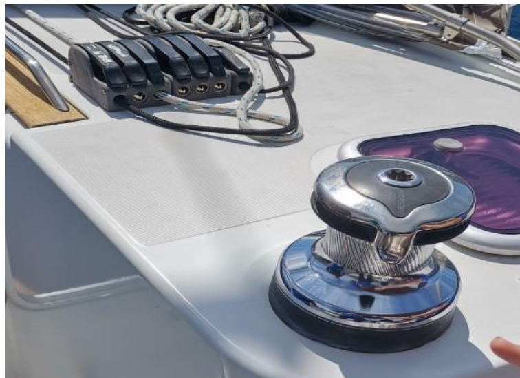
Slika 25: Kočnice za konop ili stoperi (lijevo) i vitlo (desno) (izvor: autor)
