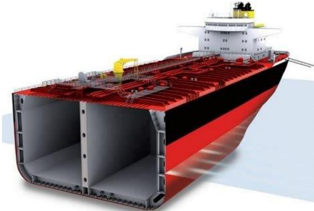
Slika 3. Primjer konstrukcije s dvostrukim trupom
