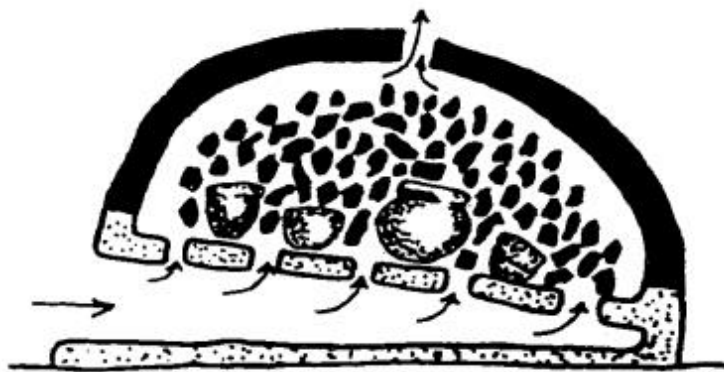
Slika 17. Pečenje s podignutom podnicom od zemlje i rešetkom.
