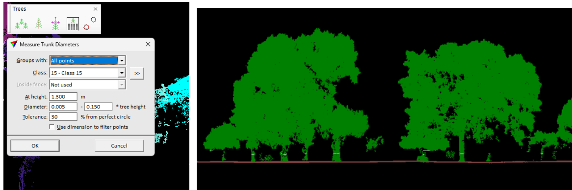
Slika 26. Alat Measure Trunk Diameters i presjek debla na visini od 1,3 m (bijela linija, desno)
