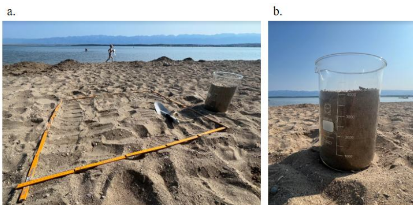
Slika 3. Postupak uzorkovanja sedimenta
