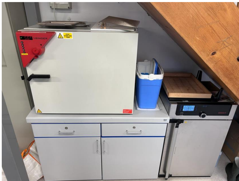
Slika 18. Komore za konvekcijsko sušenje. (izvor: autor)
