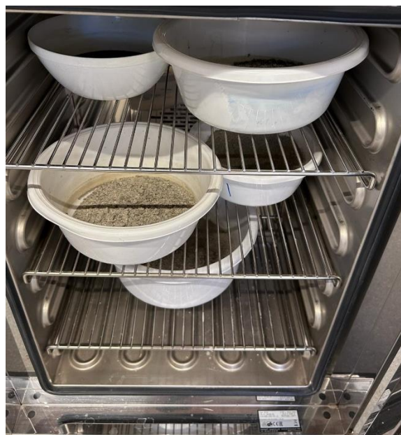
Slika 19. Uzorci unutar komore Memmert UF 75. (izvor: autor)
