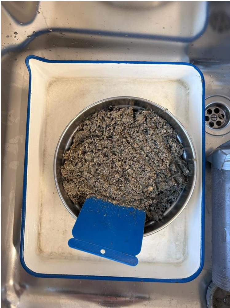
Slika 17. Prosijavanje uzorka sedimenta na čestice manje od 2 mm. (izvor: autor)
