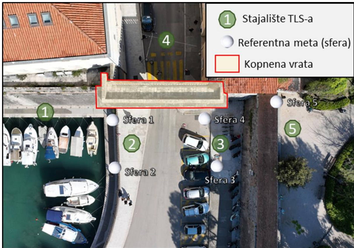
Slika 22. Plan skeniranja TLS-om
