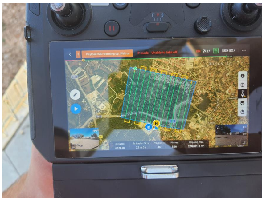
Slika 13 Misija istok-zapad prikazana na kontroloru bespilotne letjelice
