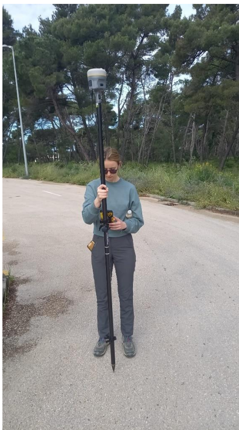
Slika 8 Prikupljanje OT i KT s Trimble R12i RTK GNSS prijemnik
