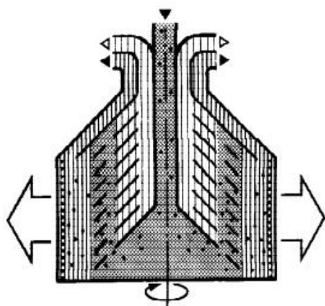
Slika 3. Centrifugalno separiranje (izvor: Manual MMPX303 Alfa Laval)
