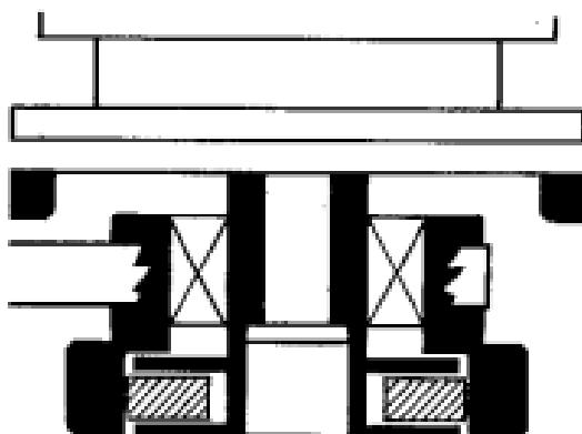
Slika 17. Prikaz tarne spojke (Izvor: Manual MMPX 303 Alfa Laval)
