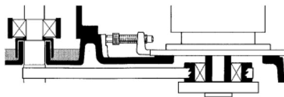
Slika 16. Pogon s remenom (Izvor: Manual MMPX 303 Alfa Laval)
