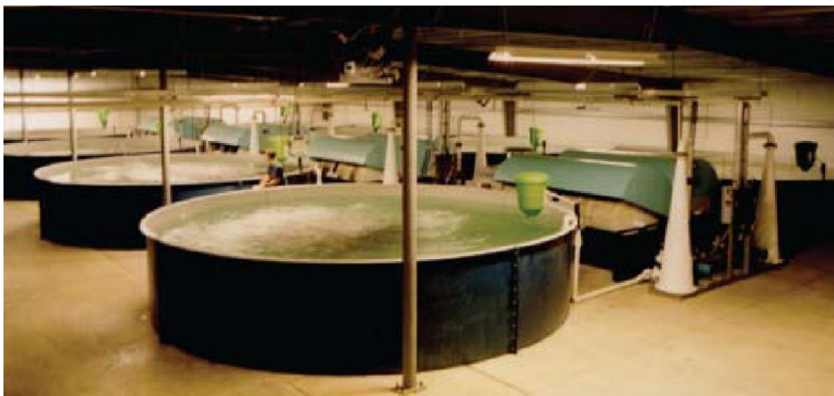
Slika 4: Zatvoreni sustav recirkulacije (Izvor:
