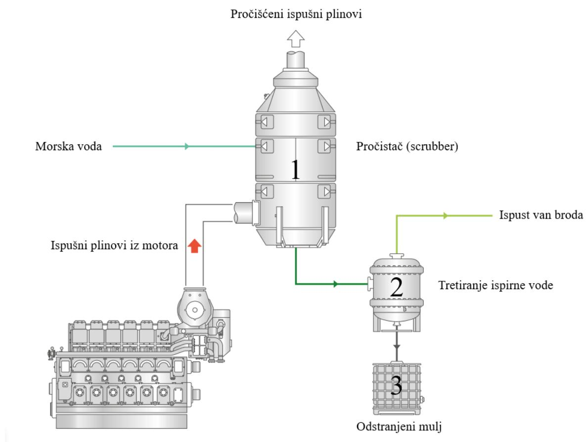
Slika 4. Osnovni elementi mokrog sustava za pročišćavanje ispušnih plinova [1]
