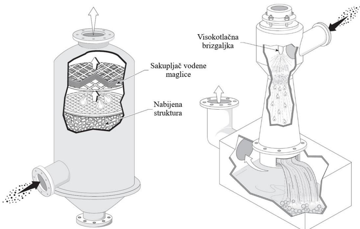
**Slika 9.** Kompaktna (lijevo) i venturi (desno)izvedba [11]
