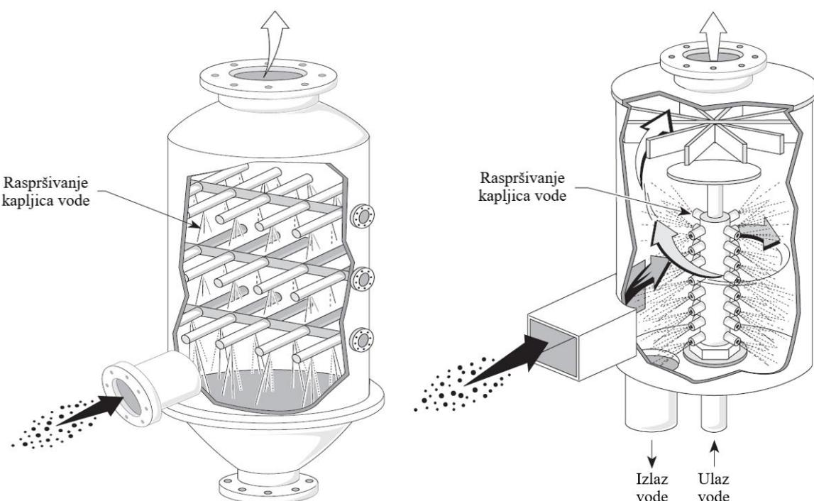
**Slika 8.** Otvoreni toranj (lijevo) i ciklonska (desno) izvedba [11]
