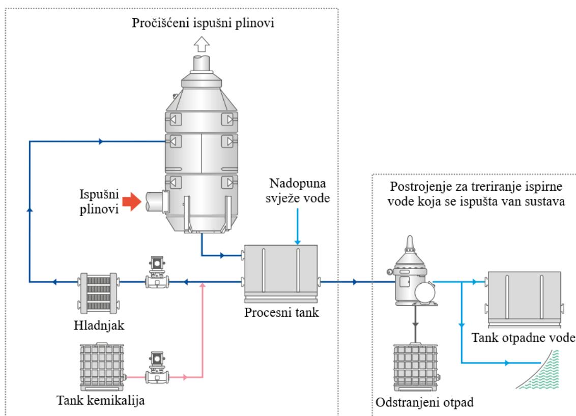
**Slika 11.** Mokri sustav za pročišćavanje ispušnih plinova u zatvorenoj petlji [1]
