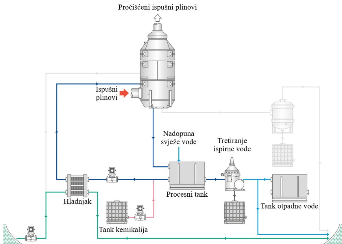
**Slika 13.** Hibridni sustav za pročišćavanje ispušnih plinova prilikom uporabe zatvorene petlje [1]
