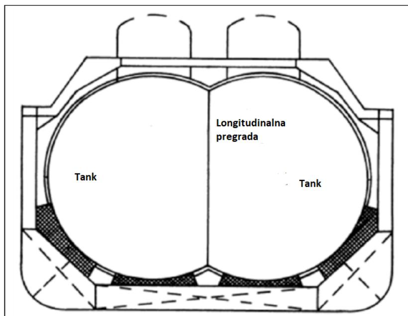
Slika 9.: Tank tip 'C' za brod pod polutlakom [10]
