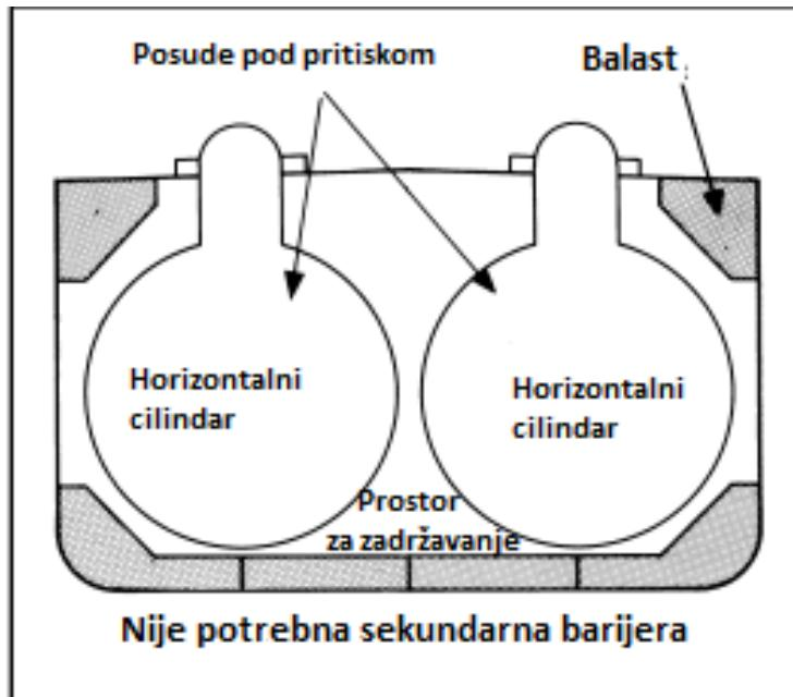
Slika 10.: Tank tip 'C' za brod pod potpunim tlakom [2]
