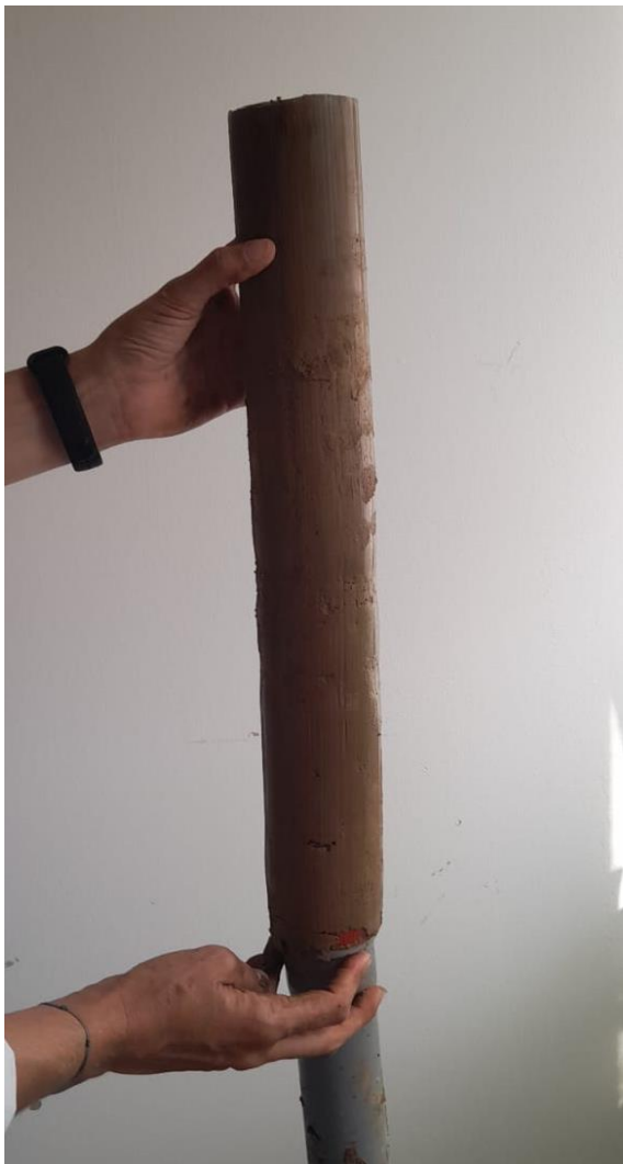
Slika 10. Prikaz izvlačenja uzorka iz korera (Izvor: vlastita fotografija)
