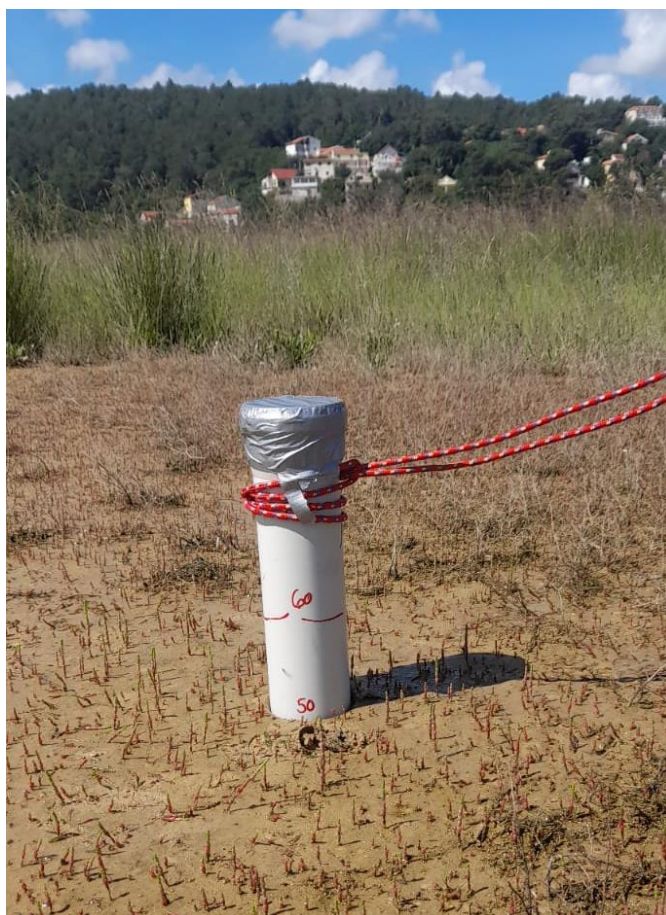
Slika 7. Zabijeni korer u tlo (Izvor: vlastita fotografija)
