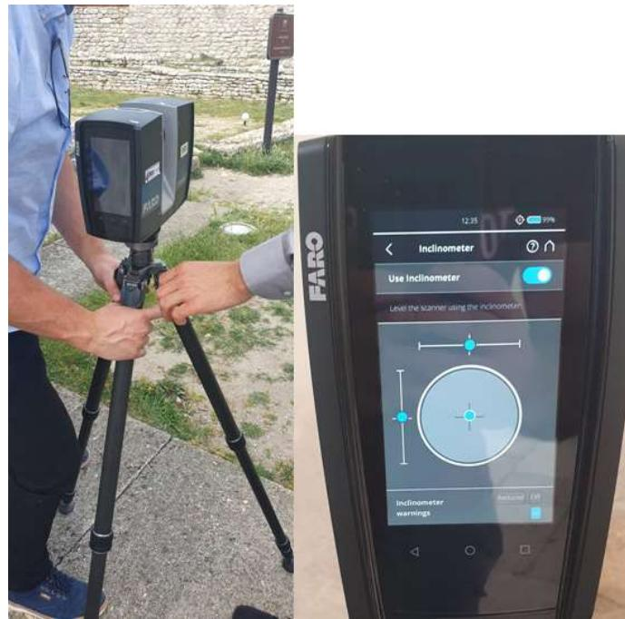
Slika 23. Postavljanje i kalibracija uređaja Faro Focus<sup>m</sup> 70
