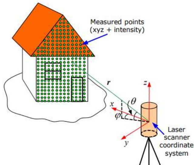
Slika 16. Princip mjerjenja pomoću terestričkog laserskog sustava (preuzeto od Reshetiyuk, 2009)
