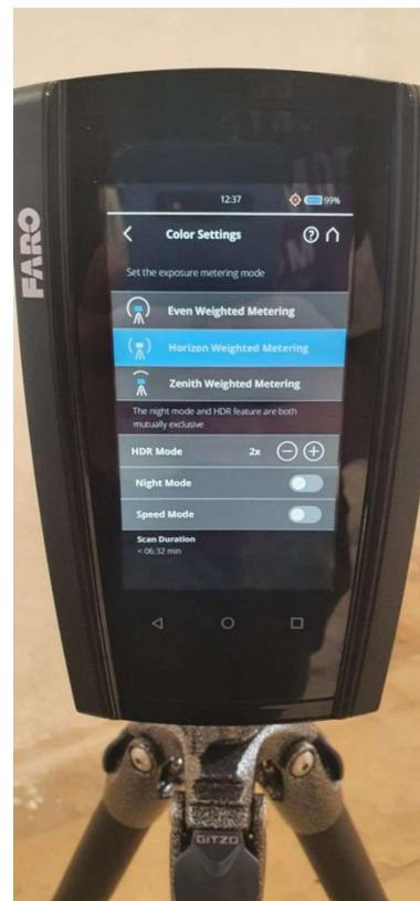
Slika 24. Određivanje postavki za RGB skeniranje na laserskom skeneru
