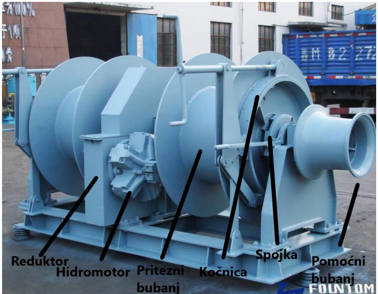
Slika 1. Dijelovi brodskog priteznog vitla [3]
