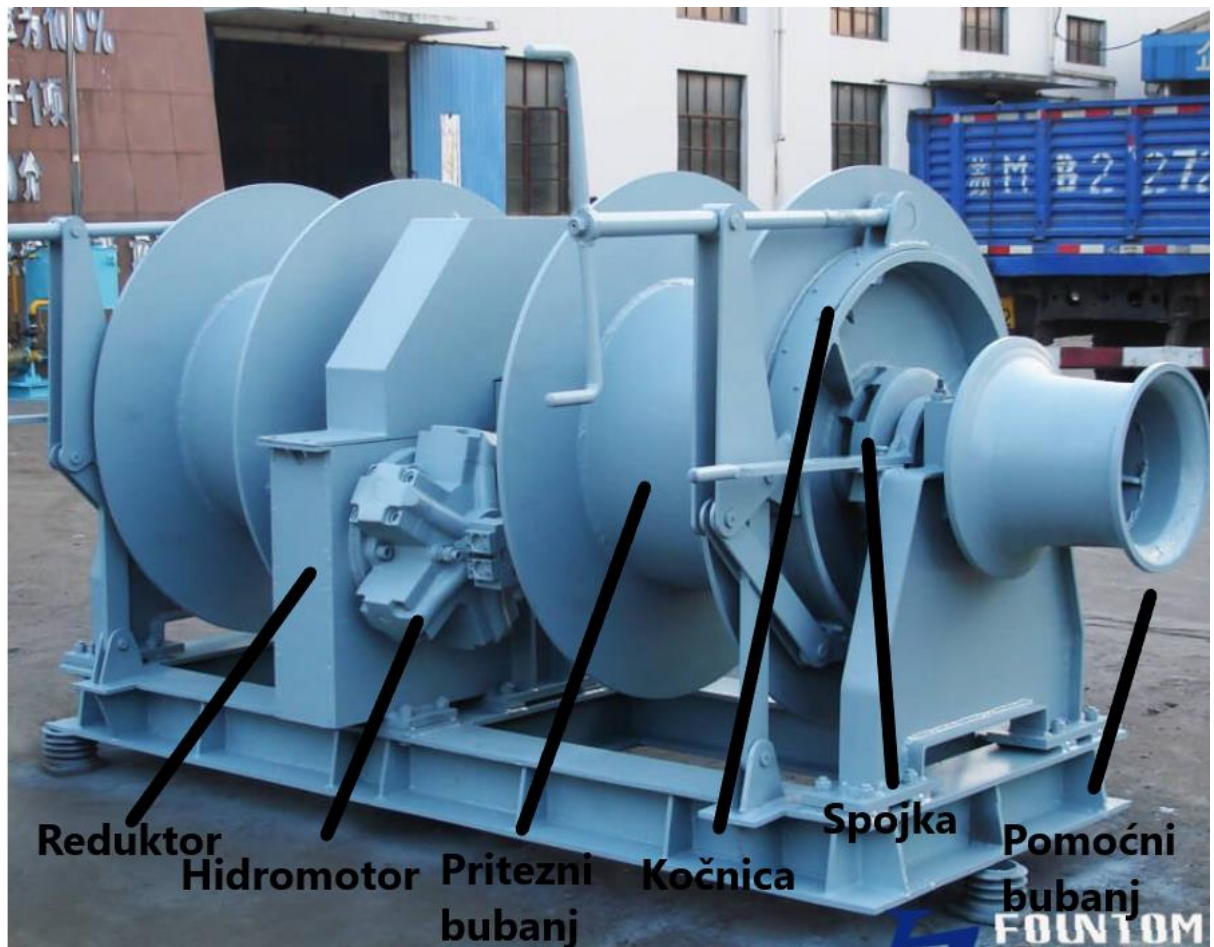
Slika 1. Dijelovi brodskog priteznog vitla [3]
