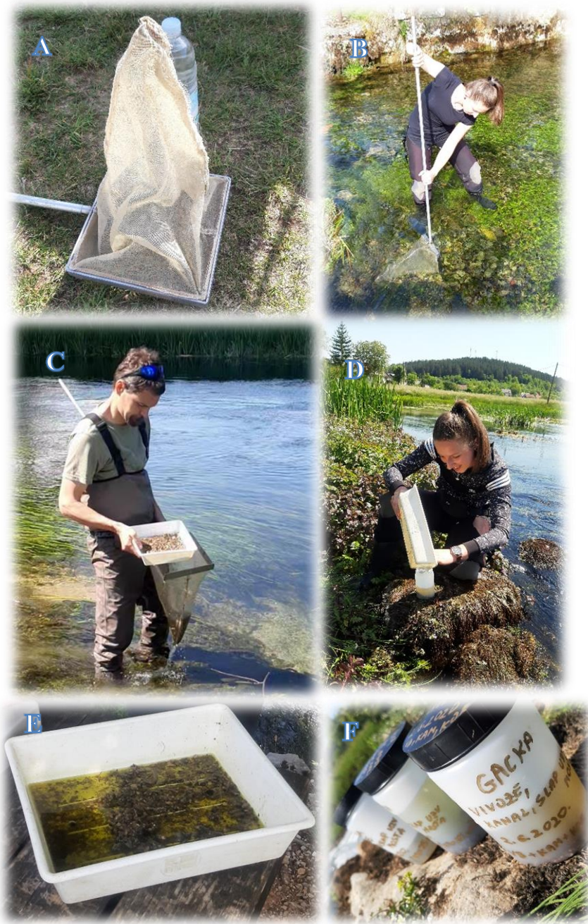
Slika 3.3. Prikaz postupka prikupljanja uzoraka: A - ručna bentos mreža (25x25cm, promjera oka mreže 500 µm); B - uzorkovanje u glavnom toku Gacke; C - postupak dekantiranja uzorka, odvajanje životinja i ostalog organskog materijala od supstrata; D - konzerviranje uzorka u bočice, E - plastične kadice s uzorkom u 96%-tnom etilnom alkoholu, F - bočice za pohranjivanje pročišćenih i konzerviranih uzoraka (Foto: KŽ i SM).
