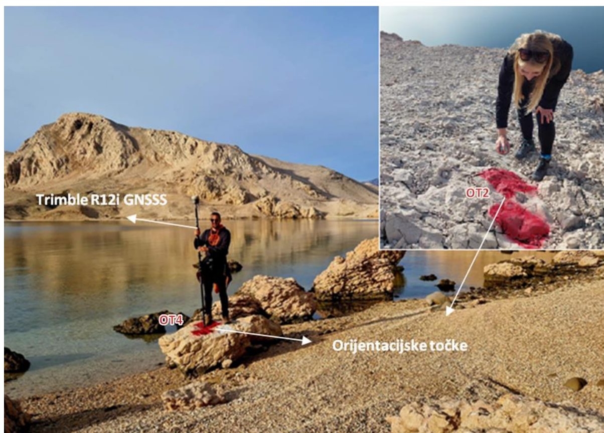
Slika 20. Označavanje i prikupljanje orijentacijskih točaka
