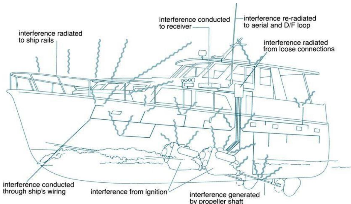
Slika 13 Izvori elektromagnetske interferencije na brodu
