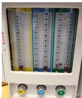
Slika 6. Mjerač protoka anestezijskih plinova
