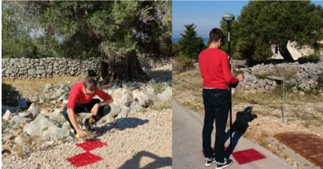
Slika 10. Označavanje i prikupljanje kontrolnih točaka
