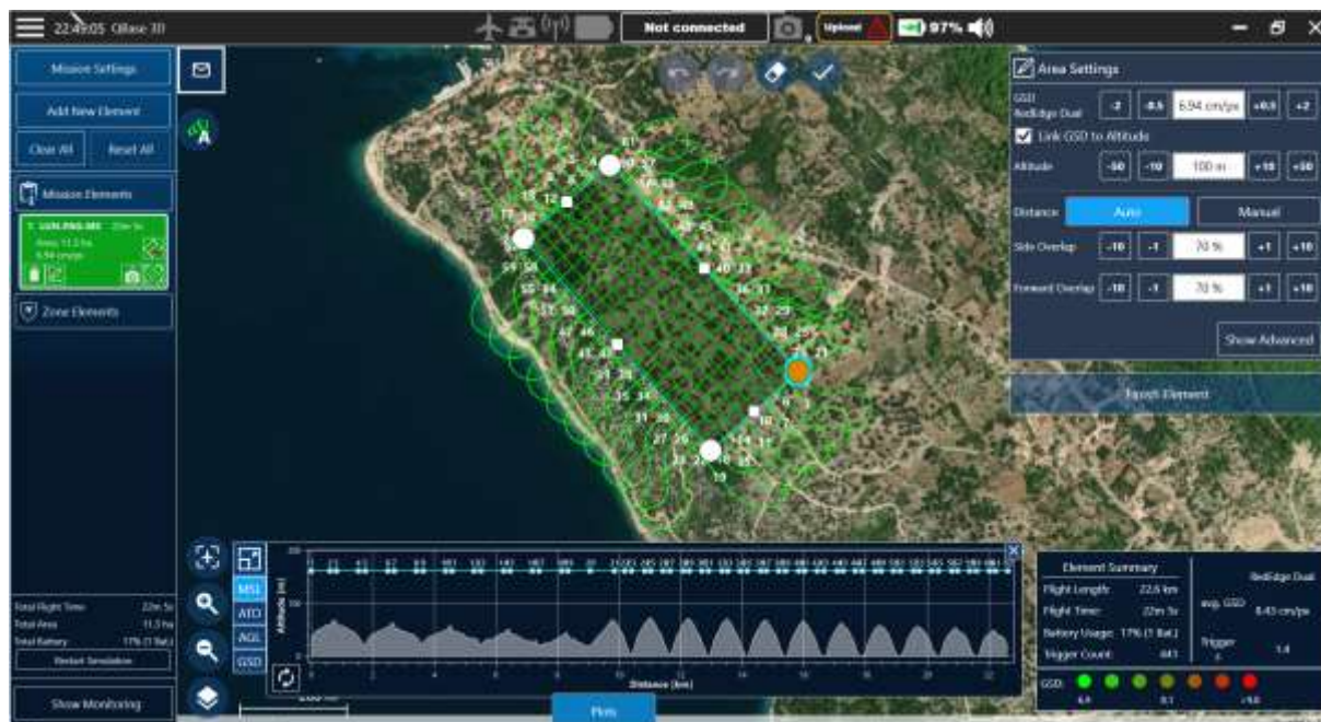
Slika 17. Plan i postavke misije s multispektralnim senzorom
