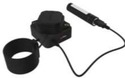
Slika 5. GNSS bazna stanica *iBase* s pripadajućom *Rugged IP67* GNSS antenom i prijenosnom baterijom (URL3)
