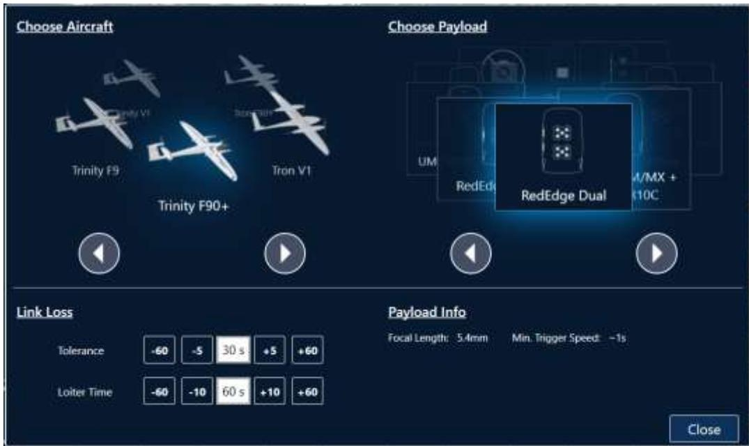
Slika 15. Odabir tipa bespilotne letjelice i vrste senzora
