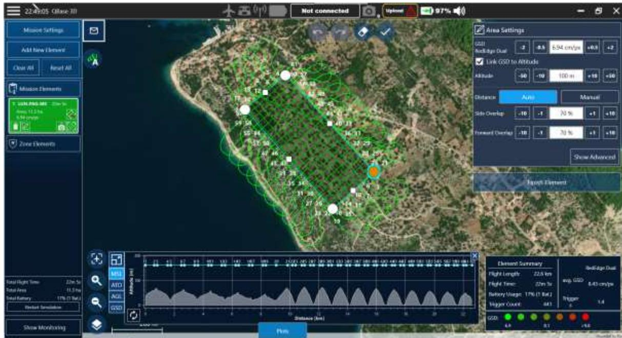
Slika 17. Plan i postavke misije s multispektralnim senzorom
