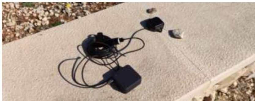
Slika 12. Referentna točka i bazna stanica iBase
