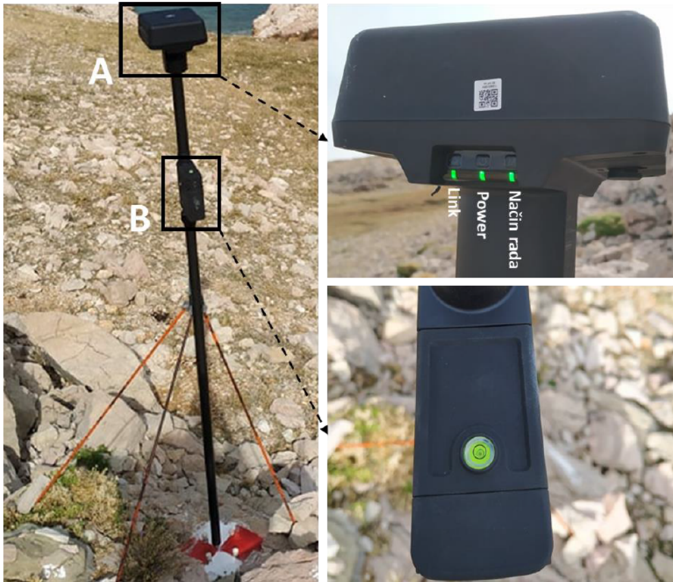
Slika 13. Montirana D-RTK mobilna stanica
