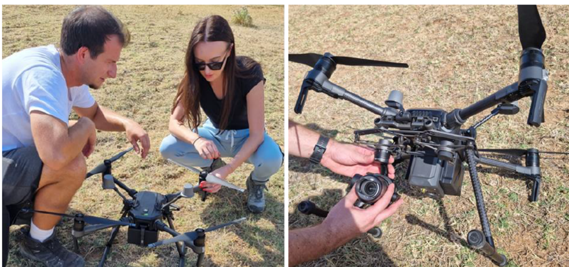
Slika 14. Spajanje UAV sustava ( Matrice 210 RTK V2 + Zenmuse X7 16 mm )
