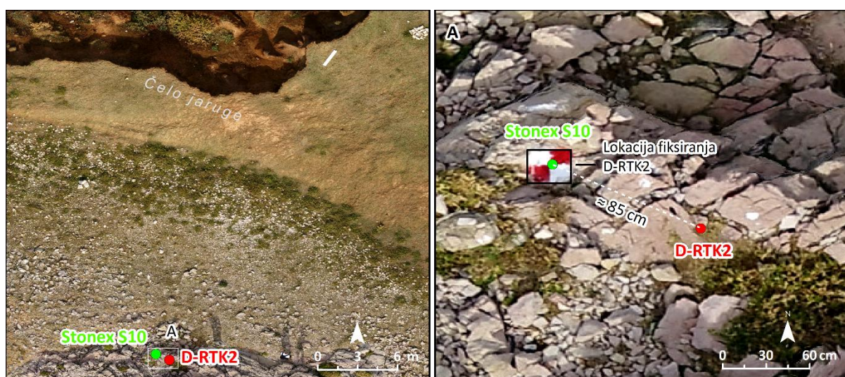
Slika 16. Geokodirana razlika u lokaciji fiksirane mobilne stanice D-RTK 2 očitane pomoću Stonexa S10 i D-RTK 2 (podloga DOF izveden koristeći 10 OT-a)
