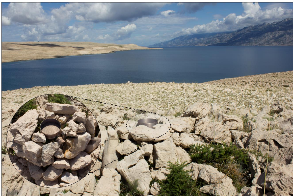
Slika 67. Jedan od dva Hobo Onset RG3-M uređaja postavljen nedaleko od jaruge Santiš Prikupljanje podataka o temperaturi zraka
