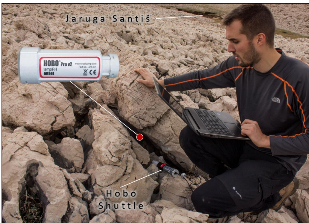
Slika 68. Lokacija postavljanja Hobo U23 Pro V2 uređaj-a nedaleko od jaruge Santiš i proces očitavanja prikupljenih podataka uz pomoć Hobo Waterproof Shuttle -a
