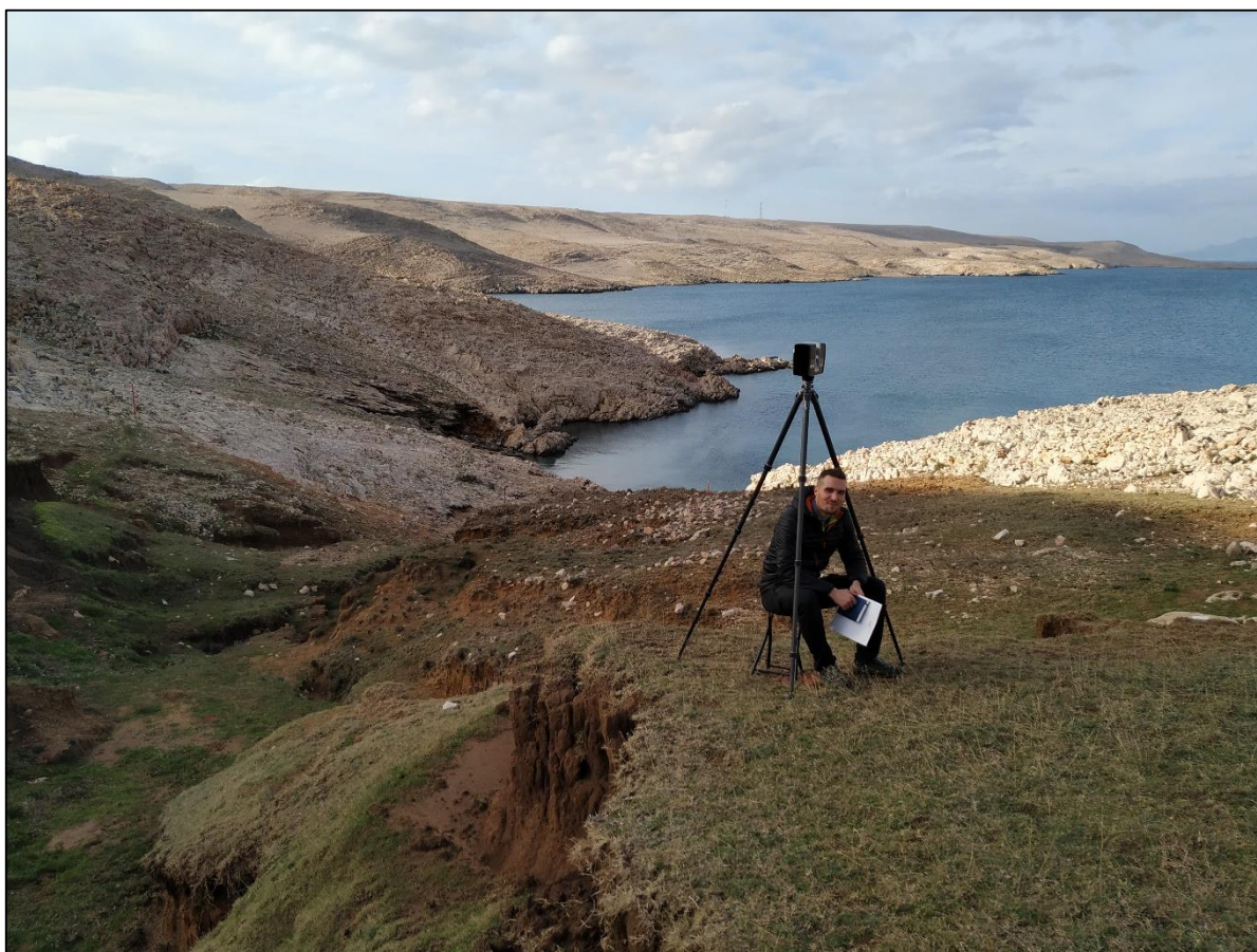
Slika 81. Skeniranje testne plohe s prvog stajališta (ST1) prilikom inicijalne TLS izmjere
