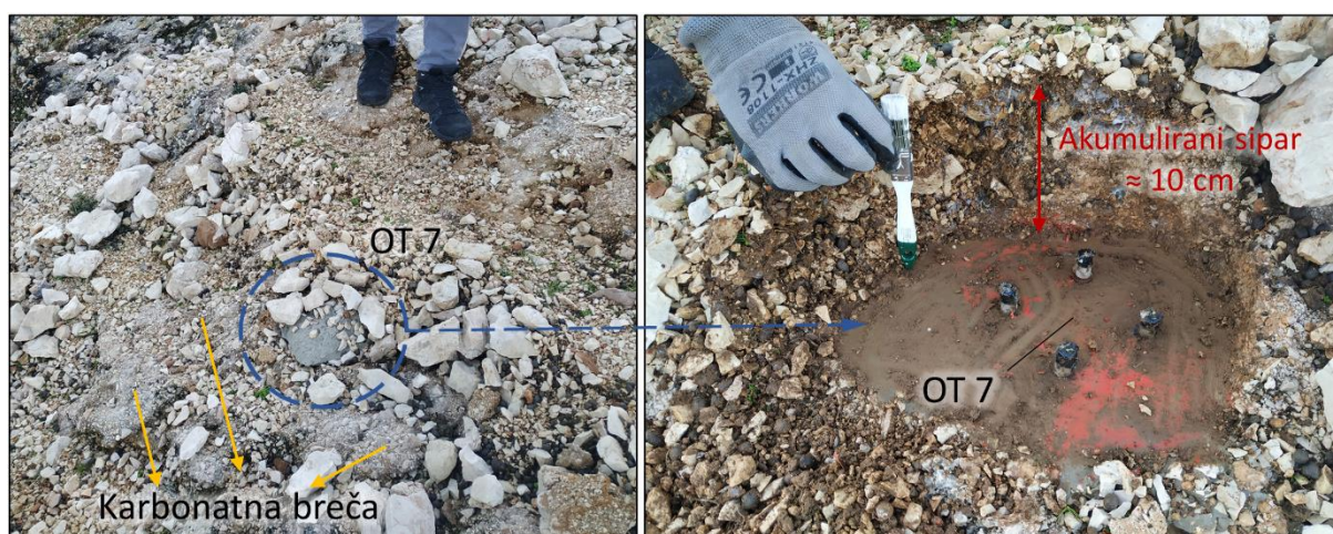
Slika 137. Akumulacija na litološkoj jedinici karbonatna breča (OT 7) uslijed transportiranja rastresitog materijala djelovanjem padinskih procesa
