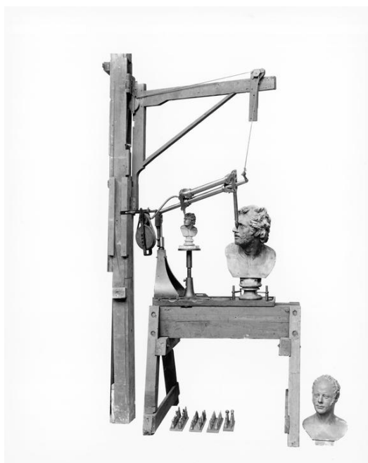
Sl. 6. Benjamin Cheverton, stroj za reprodukciju i umanjenje skulptura, Science Museum, London, 19. st.
