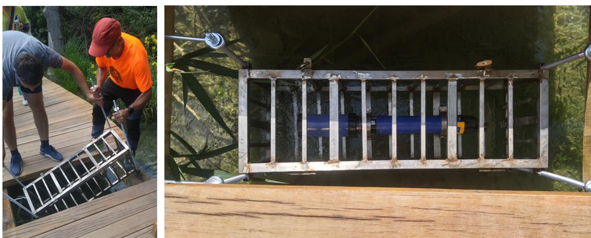
Slika 64. Postavljanje multiparametnae sonde YSI EXO2 na odabranu lokaciju
