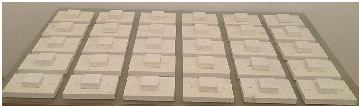
Slika 78. Pločice plano postavljene na odabranu testnu plohu
