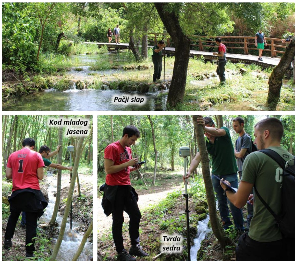
Slika 81. Prikupljanje lokacija pločica RTK-GPS-om
