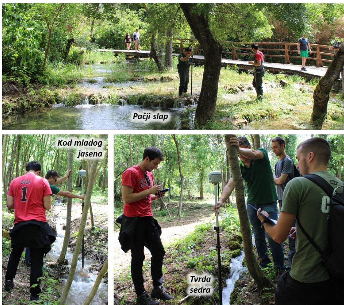
Slika 81. Prikupljanje lokacija pločica RTK-GPS-om
