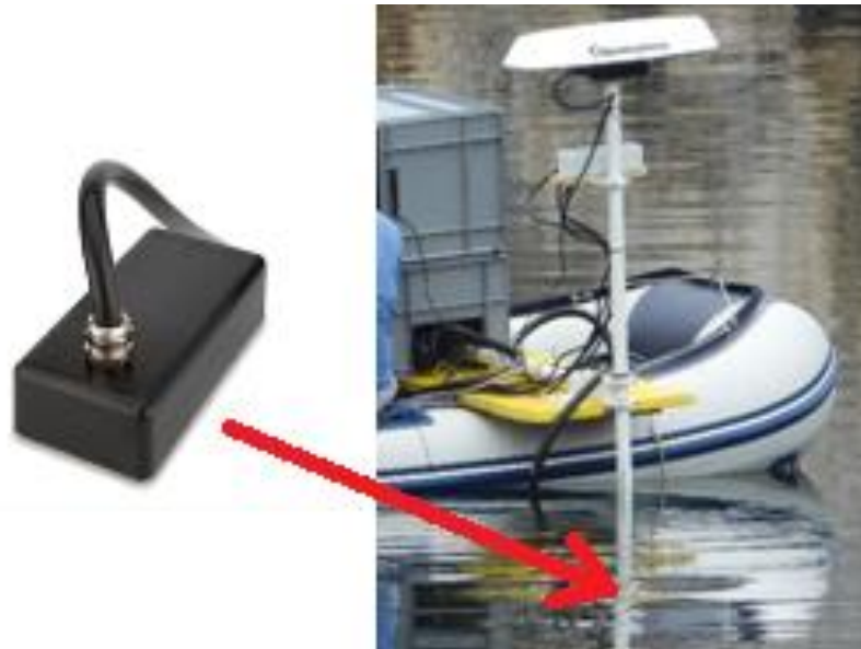
Slika 24. Sonda WMB-160 (URL9) i njezina pozicija u integralnom mjernom sustavu
