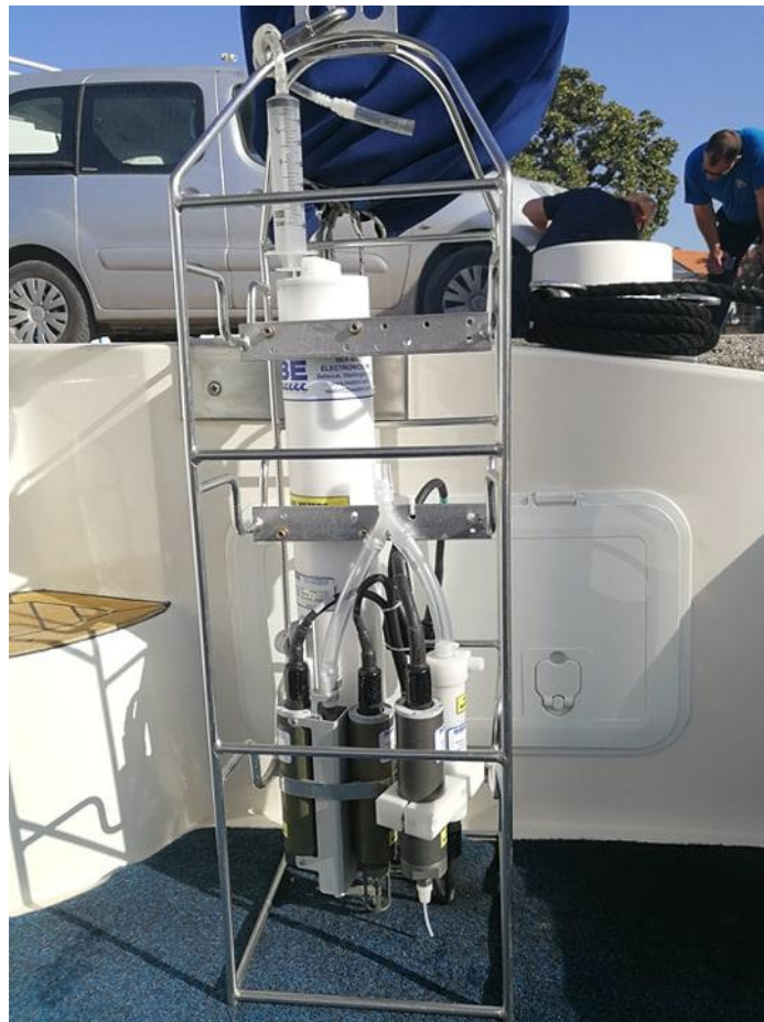
Slika 12. ECD sonda za mjerenje saliniteta i temperature
