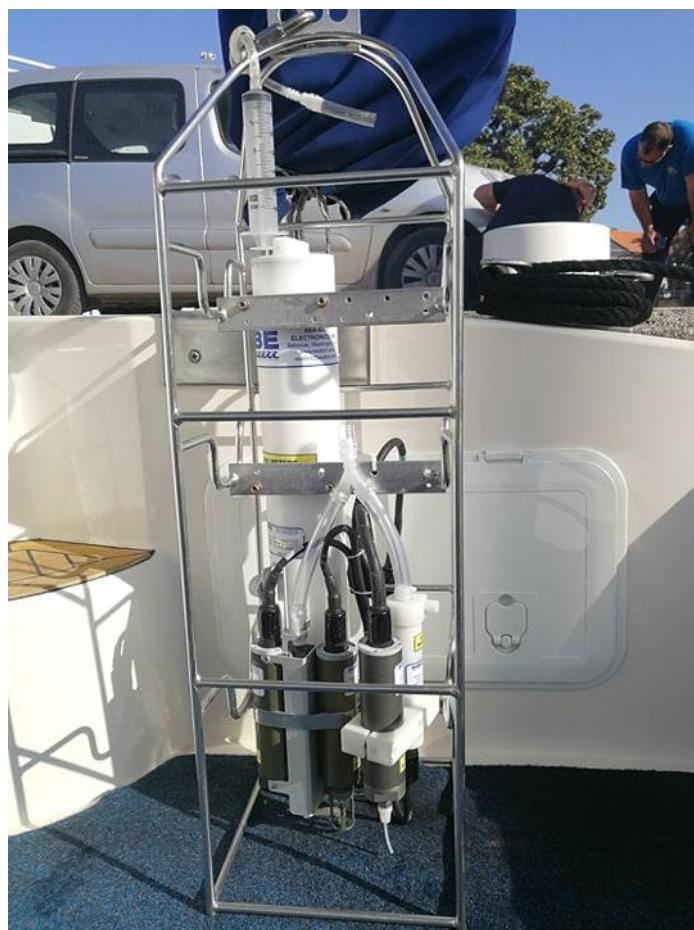
Slika 12. ECD sonda za mjerjenje saliniteta i temperature
