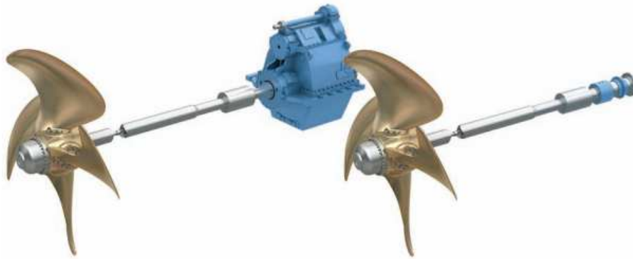
Slika 12. Propulzija s propelerom na vratilu
