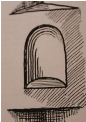
Prilog 47. Primjer niše, udubine na unutrašnjoj strani zida (vjerojatno je služila za odlaganje)
