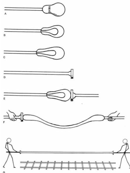
Slika 66. A. Staklena masa u obliku mjeđura na šipci, B., C. Perforiranje staklene mase, D. Druga šipka, E.-G. Izvlačenje staklenog mjeđura u tubu
