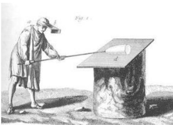
Slika 68. Obrada staklenog mjeđura na metalnoj ploči
