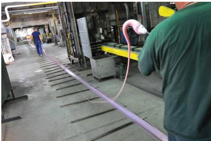
Slika 69. Današnja proizvodnja staklenih tuba ( https://www.murrina.it/en/content/4-our-factory , 2. 9. 2018.)
