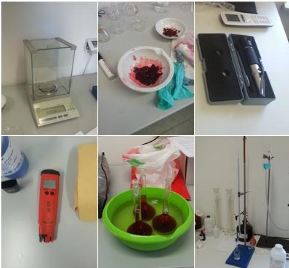
Slika 6. Kemijska analiza ploda u laboratoriju: a) analitička vaga b) keramički mužar c) refraktometar d) pH metar e) uzorci f) NaOH za titraciju ( Fotografija: orginal)
