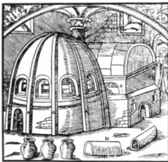
Sl. 6 - G. Agricola, De re metallica , 1556; drvorez s prikazom spojenih staklarskih peći (Davison, S., 2006, 162.)
