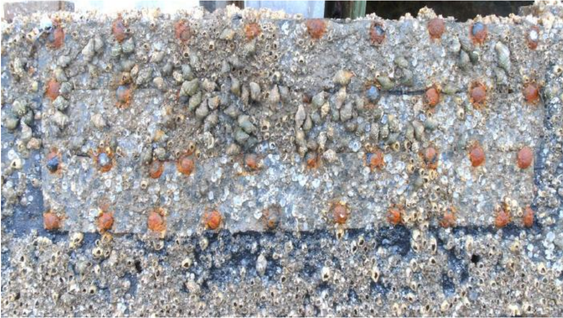
Slika 24 – Obrašaj na modelu 1 nakon njegovog vađenja iz mora (A. W. MARR, 2006, 65, fig. 11.)
