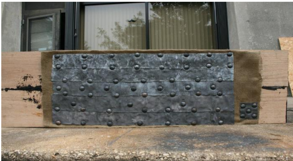
Slika 23 – Eksperimentalni model za analizu učinkovitosti olovne zaštite (A. W. MARR, 2006, 62, fig. 7.)
