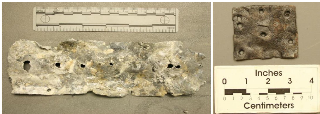
Slika 31 – Traka olovnog lima (lijevo) i olovna zakrpa (desno) s nalazišta Emanuel Point I (A. W. MARR, 2006, 36, 40, fig. 2 i 3)
