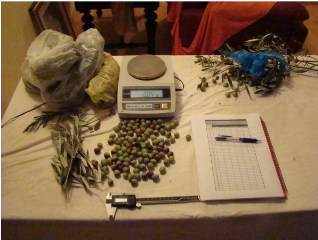
Slika 3. Pripremljeni uzorci prije mjerenja mase dužine i širine
