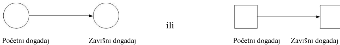
Slika 7: Primjer elementa konstrukcije mrežnog dijagrama
