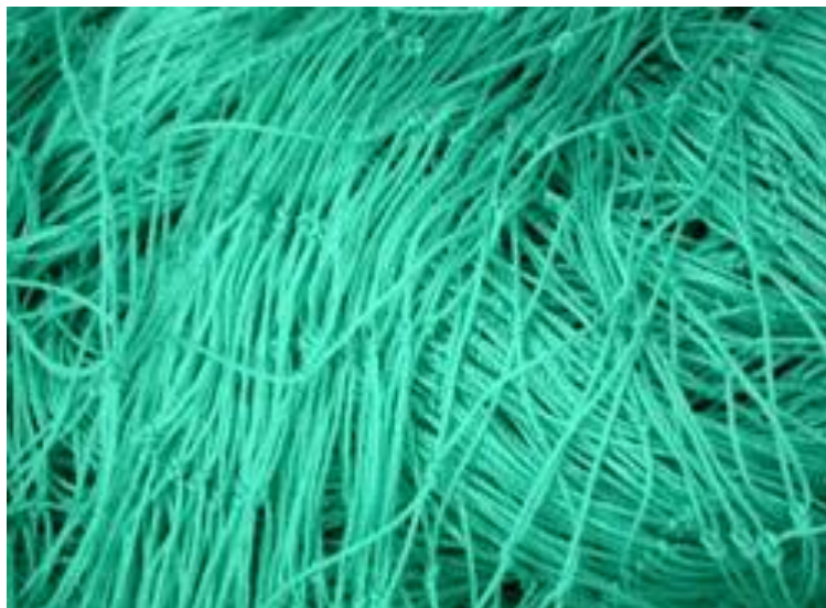
Slika 20. Prikaz materijala od polietilena (PE)
