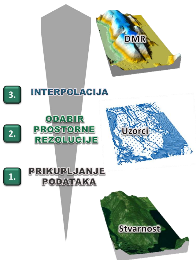
Slika 11. Temeljni korisničko-definirani parametri u procesu izrade DMR-a
